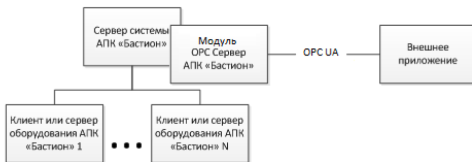
Рис. 1. Схема интеграции с использованием OPC UA Сервера АПК «Бастион-2»
